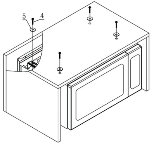
Geben Sie acht, dass der angegebene Raum zwischen Gerät und Seitenwand (mind 44 mm) immer frei bleibt!
