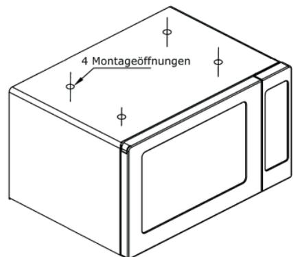
Mit den beiliegenden Schrauben und Unterlegscheiben befestigen Sie nun das Gerät an der Montageplatte.
